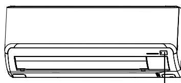
Кнопка ВКЛ/ВЫКЛ на приборе
